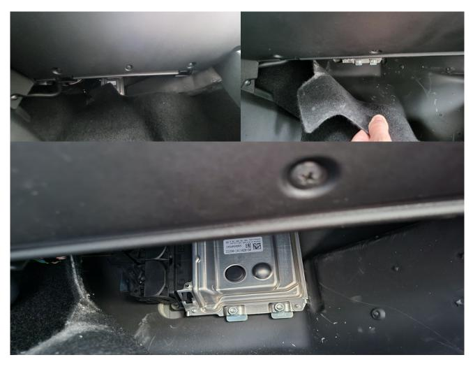
Ziehen Sie den Teppich bei Seite um an das Motorsteuergerät zu gelangen.
